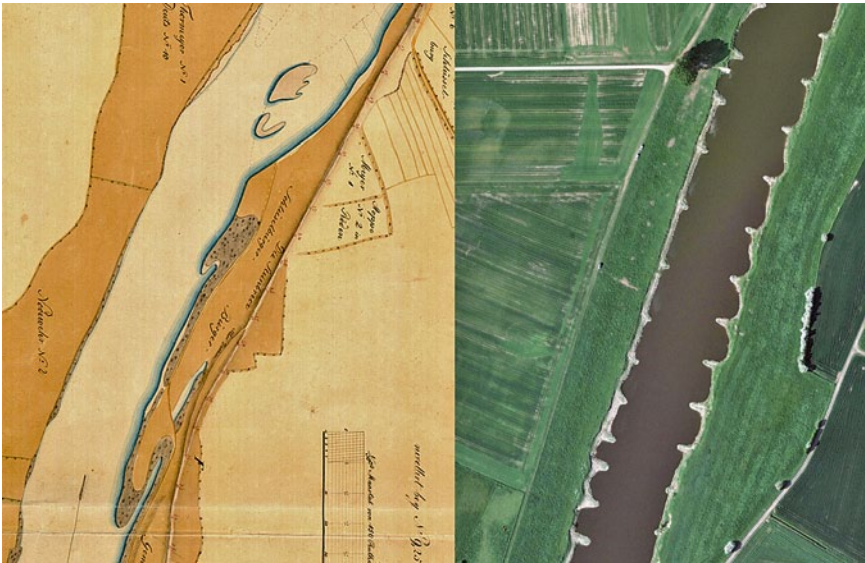
Bild 6: Weser bei A_{Eo} \sim 19\ 600\ \text{km}^2 : linkes Bild gering beeinflusst um 1825; rechtes Bild Situation heute
